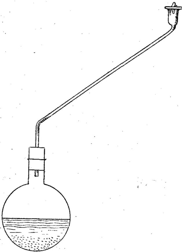
*Fig. 10.* — *Digesteur simplifié.* — Un ballon, un tube luté se terminant par un petit bouchon de verre simplement posé. Le liquide s'évapore dans les parties froides du tube et retombe; une rosace du bouchon sur la bordure du tube assure une fermeture suffisante et sans danger.
