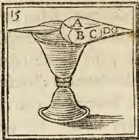
Tant que le mercure peut être contenu dans la partie *C*, le canif reste en équilibre, parce qu'alors le mercure se distribue avec égalité des deux côtés du point d'appui ; mais à force de couler, il monte enfin jusqu'à l'ouverture *D*, & passe dans la capacité *G*. Cette partie devenant alors plus lourde, il n'est pas étonnant que le canif change de place.
