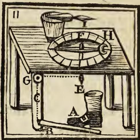
Le Faiseur de Tours avec son pied *A*, pousse la bascule *B* ; par ce moyen il tire le fil *C*, à l'aide de la poulie *G*, il fait tourner l'axe *E F* sur lequel le fil est entortillé ; par ce moyen l'aiman *H*, tourne autour de son pivot, comme l'aiguille d'une montre, & quand il arrive sous le canif *I*, dont la lame est en dehors, il lui fait faire la culbute par son attraction.
