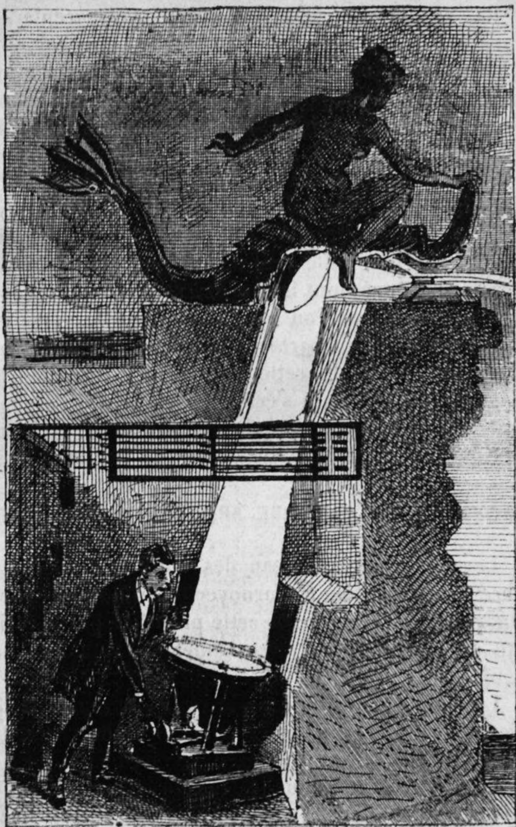
Disposition des projecteurs électriques éclairant les jets horizontaux.
